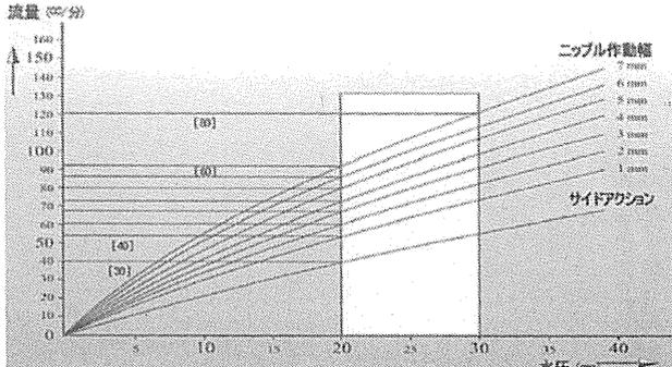
図1 ルービンニップルは、ピンの押し込み、すなわちトリの成長に合わせて流量が増加する独自開発のトップニップル。トリの能力を最大限に引き出す
